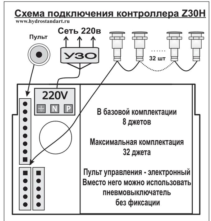
Контроллер Z30H в зависимости от типа прошивки предназначен для управления:
